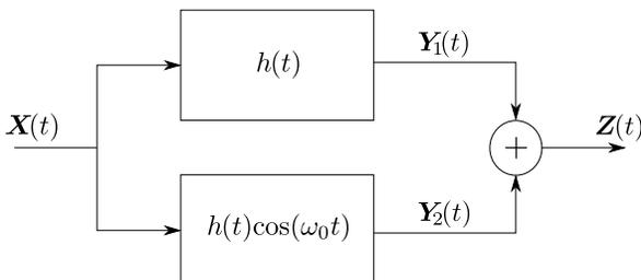
b) Se construyen los procesos  $\mathbf{Y}_1(t)$  e  $\mathbf{Y}_2(t)$  como se indica en la figura, donde la respuesta al impulso  $h(t)$  es la correspondiente a un filtro paso bajo ideal de ganancia unidad y ancho de banda  $\Delta\omega$ , con  $\Delta\omega \ll \omega_0$  (el filtro, en consecuencia, deja pasar únicamente las pulsaciones en la banda  $[-\Delta\omega, \Delta\omega]$ ). Se pide que justifique si los procesos  $\mathbf{Y}_1(t)$  y  $\mathbf{Y}_2(t)$  son incorrelados.
