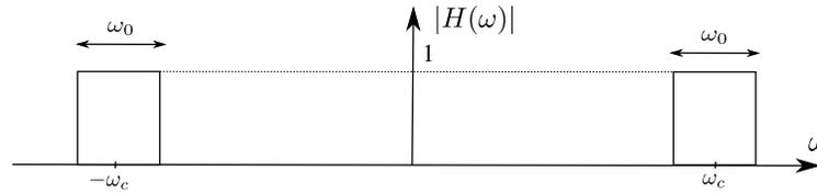
Obtenga y represente la densidad espectral de potencia del proceso  $\mathbf{Z}(t)$  obtenido a la salida del sistema si la densidad espectral del proceso  $\mathbf{X}(t)$  viene dada por la siguiente expresión
