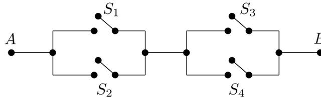
a) Suponga que  $P(S_1) = P(S_3) = p$ , que  $P(S_2|S_1) = P(S_4|S_3) = p_{c1}$  y que  $P(S_2|\bar{S}_1) = P(S_4|\bar{S}_3) = p_{c2}$ . Calcule la probabilidad de que haya corriente entre los puntos  $A$  y  $B$ .
