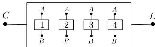
Con esta configuración para que haya corriente entre los puntos  $C$  y  $D$ , tienen que conducir exactamente 3 de los 4 circuitos  $AB$ . Considere que la probabilidad de que el primer circuito  $AB_1$  conduzca es  $p$ , que el circuito  $AB_j$  sólo depende del circuito  $AB_{j-1}$  para  $j=2, 3, 4$  y que  $P(AB_j|AB_{j-1})=pc_1$  y  $P(AB_j|\overline{AB_{j-1}})=pc_2$ . Determine la probabilidad de que haya corriente entre  $C$  y  $D$ .
