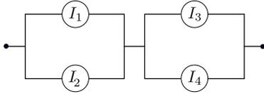
a) Asuma que la probabilidad de funcionamiento correcto de los bloques cumple que  $P(I_i) = p$ , con  $i = \{1, 2, 3, 4\}$  y que  $P(I_3|I_1) = P(I_4|I_2) = p_c$ . Determine la probabilidad  $p^a$  de que el dispositivo funcione correctamente.
