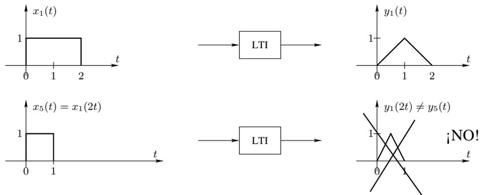
Para calcular la salida debemos usar únicamente desplazamientos y cambios de nivel sobre la entrada conocida, dado que sólo conocemos la salida correspondiente a  $x_1(t)$  y que el sistema es LTI. Si vamos sumando y restando sucesivas veces  $x_1(t)$  y versiones desplazadas entre sí 1 segundo:
