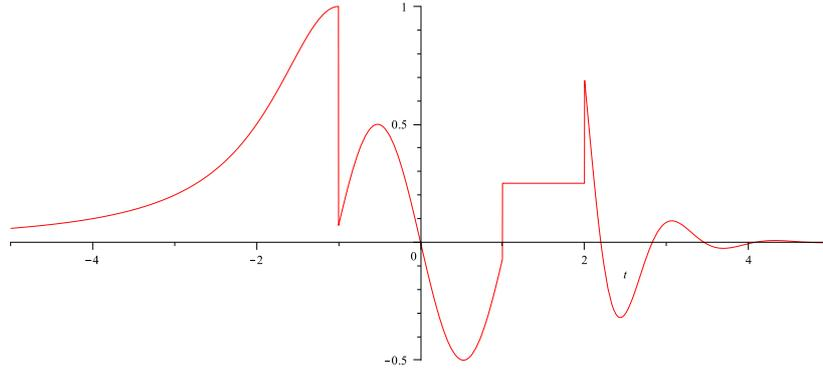
**Figura 6:** Ejemplo de señal continua a tramos. Este tipo de señales no contiene distribuciones delta de Dirac ni tampoco singularidades.
