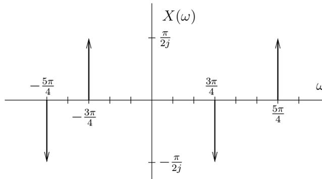
La frecuencia máxima de la señal va a ser  $\omega_m = \frac{5\pi}{4}$ , con lo que la frecuencia de Nyquist será el doble de la frecuencia máxima:
