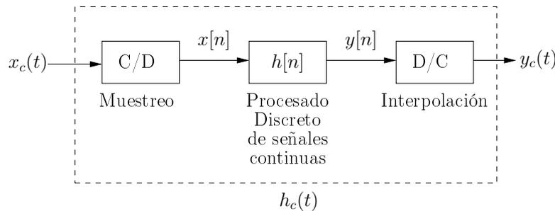
con una etapa de muestreo sin aliasing y una etapa de interpolación. Para muestrear la señal sin aliasing, en este caso, necesitamos muestrear por encima de la frecuencia de Nyquist:
