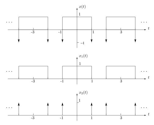
Los coeficientes de la serie de Fourier cumplen la propiedad de linealidad si las señales involucradas comparten el mismo periodo. Esta condición se cumple para  $x_1(t)$  y  $x_2(t)$ , puesto que ambas comparten el periodo de la señal global, T=3. Siendo así, los coeficientes de la serie de Fourier de x(t) serán  $c_k=d_k-e_k$ , donde  $d_k$  y  $e_k$  son los coeficientes correspondientes a  $x_1(t)$  y  $x_2(t)$ , respectivamente.
