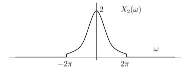
Al muestrear con un tren de deltas, la señal se replica en los múltiplos enteros de la frecuencia de muestreo y su altura se divide por T:
