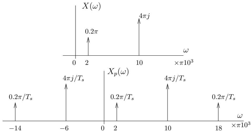
Para recuperar una señal muestreada a  $\omega_s$  debemos usar un filtro pasabajo con frecuencia de corte  $\omega_c = \omega_s/2$  y ganancia  $T_s$
