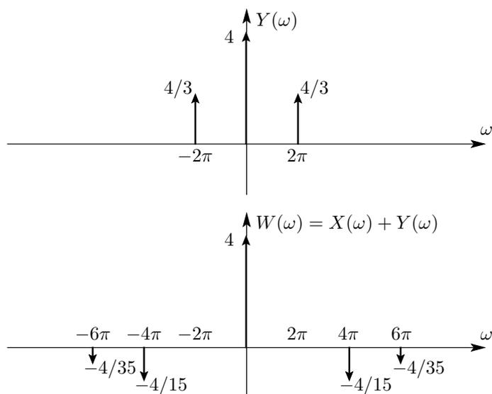
Finalmente, al pasar por el filtro paso bajo con respuesta al impulso, en frecuencia,  $H(\omega)$ , sólo permanecen en la señal resultante,  $Z(\omega)$ , las componentes con frecuencia  $|\omega| \leq 5\pi$ , como se ve en la Figura 4.
