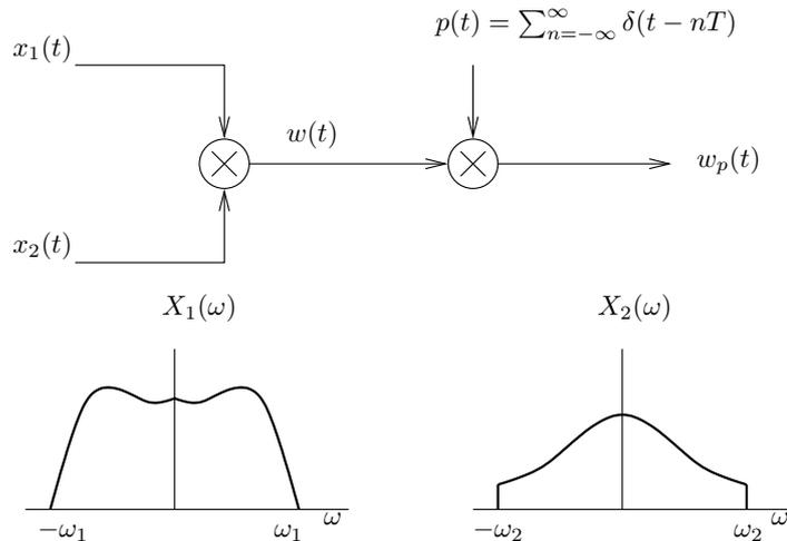
se multiplican dos funciones de tiempo  $x_1(t)$  y  $x_2(t)$ , y el producto  $w(t)$  se muestra con un tren de impulsos. la función  $x_1(t)$  es de banda limitada a  $\omega_1$  y  $x_2(t)$  es de banda limitada a  $\omega_2$ ; esto es
