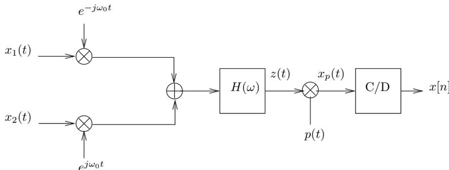
$H(\omega)$  es un filtro pasabajo ideal de ganancia 1 y frecuencia de corte  $\omega_0$ , y  $p(t) = \sum_{k=-\infty}^{\infty} \delta(t - kT)$ , con  $T = \pi/\omega_0$ .
