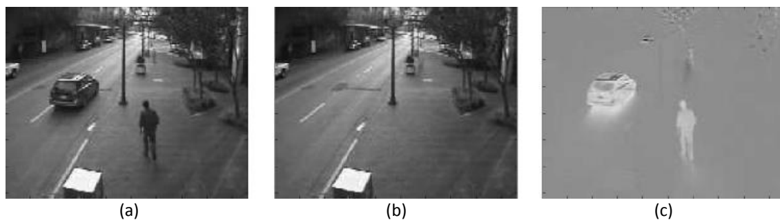
Figura 2.2. Substracción del fondo por descomposición en autoespacios
