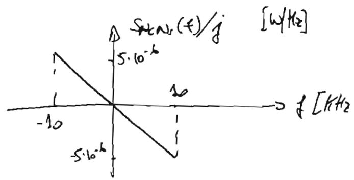
(g)  $S_{y_n}(f) = \frac{1}{8} \left[ S_{Nc}(f - \frac{\omega}{2}) + S_{Nc}(f + \frac{\omega}{2}) \right]$  (1ª parte)
