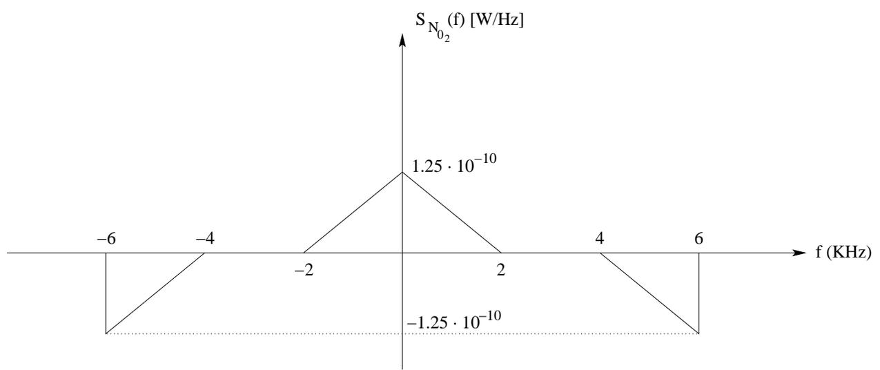
Finalmente en la siguiente figura podemos ver la densidad espectral de potencia de la componente de ruido a la salida:
