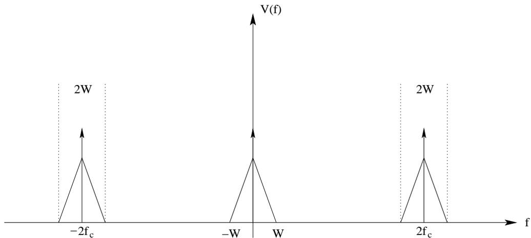
Ahora mediante un filtro paso bajo de ancho de banda  $W$  se tiene la señal a la salida del detector coherente:
