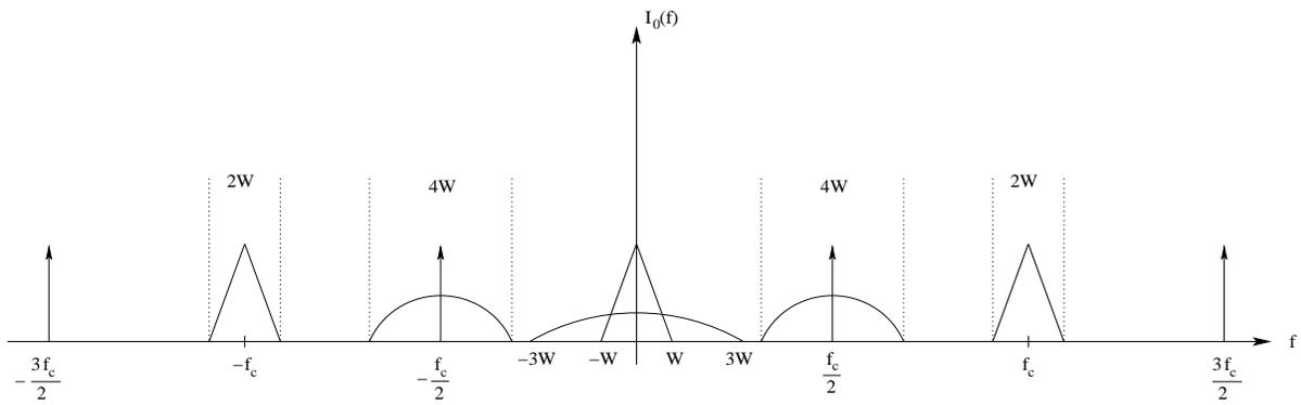
Para extraer una señal DSB centrada en  $f_c$  se puede utilizar un filtro paso banda con frecuencia central  $f_c$  y ancho de banda  $B_w$  que cumpla:
