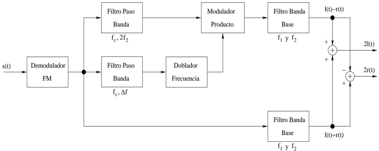
d) En la siguiente figura se puede ver cuál sería el esquema del receptor de FM monofónico:
