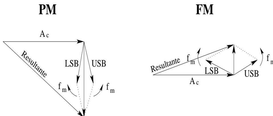
En ambos casos la suma de las bandas laterales está en cuadratura con la portadora. Cuando en FM la suma de las bandas laterales toma su valor máximo, en PM es cero, por tanto, la diferencia entre ambos diagramas fasoriales es debido a un desfase de  $90^\circ$ .
