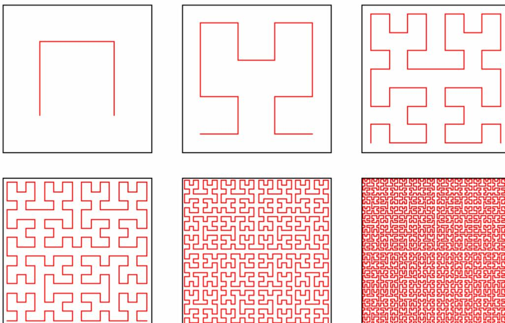
La curva de Hilbert se construye iterando mediante el procedimiento que puede observarse en la figura anterior. En cada etapa cada segmento se sustituye por otros cuatro con la mitad de longitud. La curva límite de tales poligonales llena el cuadrado unidad, por tanto, la curva de Hilbert tiene una dimensión de Hausdorff igual a 2.
