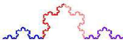
La construcción de reemplazar cada segmento por otros cuatro, cada uno de longitud  $1/3$   $x$  (longitud del segmento considerado en la etapa anterior) puede aplicarse, por ejemplo, a los lados del triángulo equilátero de lado 1. Obteniendo, una sucesión de figuras como la que se muestra abajo
