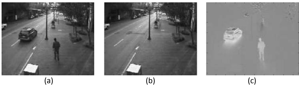
Figura 2.2. Substracción del fondo por descomposición en autoespacios
